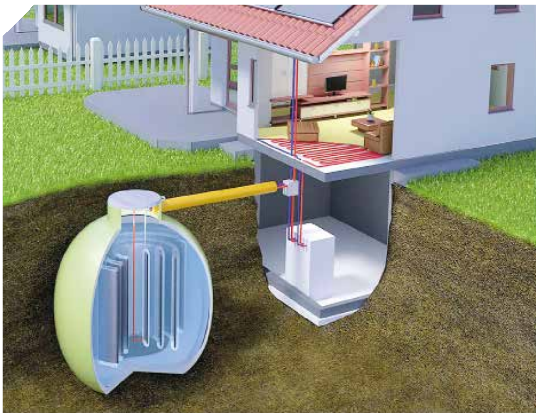
Eisspeicher sind einfache, unterirdische Tanks.
