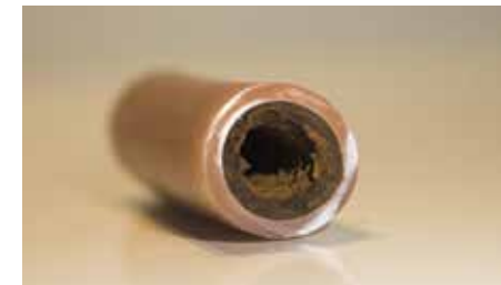
Versprödetes und verschlammtes Bodenheizungsrohr.
