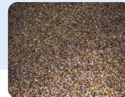
Werden Wasserenthärtungsanlagen nicht regelmässig desinfiziert, wachsen auf dem Ionenaustauscherharz Bakterien und Pilze.
