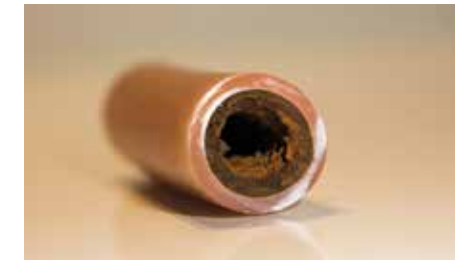
Versprödetes und verschlammtes Bodenheizungsrohr.
